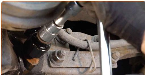
8 Αφαιρέστε τη βίδα στερέωσης. Χρησιμοποιήστε ένα ίσιο σκαρπέλο μετάλλου. Χρησιμοποιήστε ένα σφυρί.
