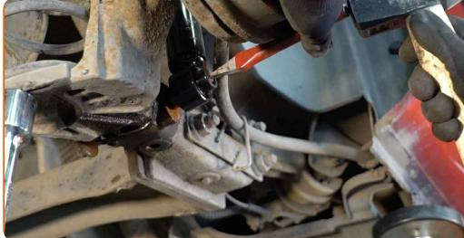
9 Αφαιρέστε τη βάση κάτω από τον πίσω εγκάρσιο άξονα.
