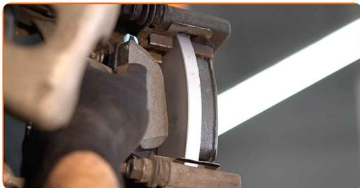
**33** Τοποθετήστε τη δαγκάνα του φρένου και σφίξτε τη. Χρησιμοποιήστε ένα γερμανοπολύγωνο #13. Χρησιμοποιήστε ένα γερμανοπολύγωνο #15. Χρησιμοποιήστε ένα καρυδάκι #13. Χρησιμοποιήστε ένα δυναμόκλειδο. Σφίξτε τη με ροπή 35 Nm.
