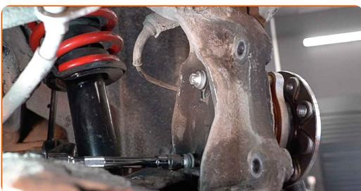
**26** Περάστε από επεξεργασία το τμήμα της πλήμνης του τροχού που έρχεται σε επαφή με το δίσκο του φρένου. Χρησιμοποιήστε γράσο χαλκού.
