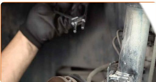
**23** Καθαρίστε τη βάση της δαγκάνας των φρένων από τη βρωμιά και τη σκόνη. Χρησιμοποιήστε μια συρματόβουρτσα. Χρησιμοποιήστε καθαριστικό φρένων.
