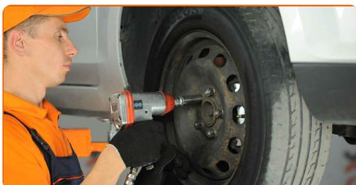
**44** Χαμηλώστε το αυτοκίνητο και χρησιμοποιήστε σταυρό, προκειμένου να σφίξετε τα μπουλόνια των τροχών. Χρησιμοποιήστε κρουστικό καρυδάκι για μπουλονόκλειδο Νο #19. Χρησιμοποιήστε ένα δυναμόκλειδο. Σφίξτε τη με ροπή 120 Nm.
