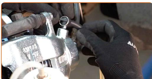
**34** Ξεσφίξτε τη βίδα εξαέρωσης των φρένων. Χρησιμοποιήστε ένα γερμανοπολύγωνο #9.
