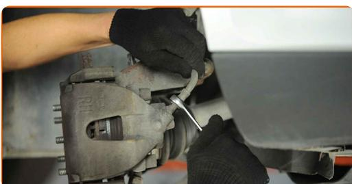
**12** Καθαρίστε τα στοιχεία στερέωσης της δαγκάνας των φρένων. Χρησιμοποιήστε μια συρματόβουρτσα. Χρησιμοποιήστε σπρέι WD-40.
