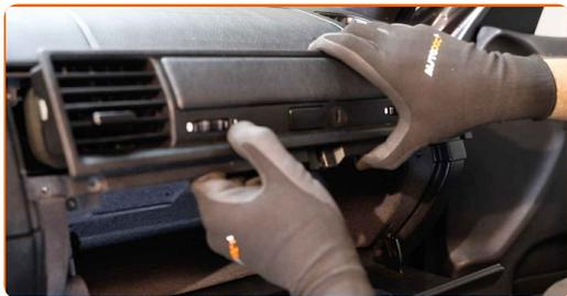
**5** Ξεβιδώστε τις βίδες συγκράτησης του ντουλαπιού του συνοδηγού. Χρησιμοποιήστε ένα σταυροκατσάβιδο. Χρησιμοποιήστε ένα ίσιο κατσαβίδι.
