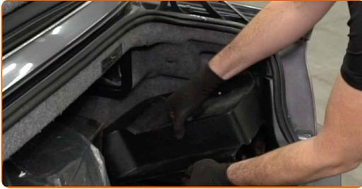
5 Ξεβιδώστε το στοιχείο στερέωσης του αρνητικού πόλου της μπαταρίας. Χρησιμοποιήστε ένα καρυδάκι #10. Χρησιμοποιήστε μια καστάνια.
