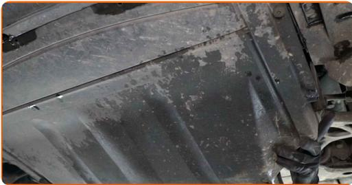
10 Σφίξτε τα στοιχεία στερέωσης βραχίονα ενίσχυσης υποπλαισίου. Χρησιμοποιήστε ένα υδραυλικό γρύλο σασμάν.
