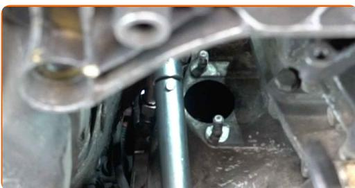
**70** Σφίξτε τα στοιχεία στερέωσης που συνδέουν το κιβώτιο ταχυτήτων στο μπλοκ κινητήρα. Χρησιμοποιήστε ένα Τορξ Ε14. Χρησιμοποιήστε ένα δυναμόκλειδο. Σφίξτε τη με ροπή 72 Nm.
