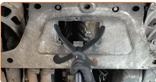
11 Ξεβιδώστε τα στοιχεία στερέωσης του βραχίονα ενίσχυσης υποπλαισίου. Χρησιμοποιήστε ένα καρυδάκι #16. Χρησιμοποιήστε μια καστάνια.
