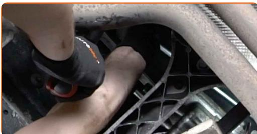
**71** Σφίξτε τα κάτω στοιχεία στερέωσης που συνδέουν το κιβώτιο ταχυτήτων με τον κινητήρα. Χρησιμοποιήστε ένα Τορξ Ε11. Χρησιμοποιήστε ένα δυναμόκλειδο. Σφίξτε τη με ροπή 22 Nm.
