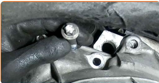
**68** Βιδώστε τα στοιχεία στερέωσης που συνδέουν το κιβώτιο ταχυτήτων στο μπλοκ κινητήρα. Χρησιμοποιήστε ένα Τορξ Ε14. Χρησιμοποιήστε μια κασάνια.
