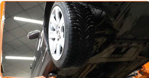
8 Ξεβιδώστε τα στοιχεία στερέωσης της προστατευτικής ποδιάς του κινητήρα. Χρησιμοποιήστε ένα σταυροκατσάβιδο.
