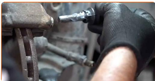
**21** Σφίξτε τα στοιχεία στερέωσης της δαγκάνας του φρένου. Χρησιμοποιήστε ένα γερμανοπολύγωνο #19. Χρησιμοποιήστε ένα καρυδάκι #13. Χρησιμοποιήστε ένα δυναμόκλειδο. Σφίξτε τη με ροπή 30 Nm.
