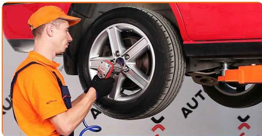
**26** Χαμηλώστε το αυτοκίνητο και χρησιμοποιήστε σταυρό, προκειμένου να σφίξετε τα μπουλόνια των τροχών. Χρησιμοποιήστε κρουστικό καρυδάκι για μπουλονόκλειδο No #19. Χρησιμοποιήστε ένα δυναμόκλειδο. Σφίξτε τη με ροπή 90 Nm.
