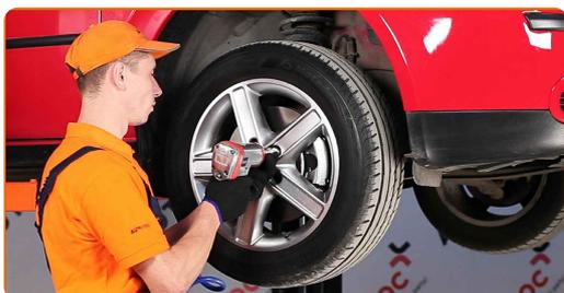
**23** Χαμηλώστε το αυτοκίνητο και χρησιμοποιήστε σταυρό, προκειμένου να σφίξετε τα μπουλόνια των τροχών. Χρησιμοποιήστε κρουστικό καρυδάκι για μπουλονόκλειδο Νο #19. Χρησιμοποιήστε ένα δυναμόκλειδο. Σφίξτε τη με ροπή 90 Nm.
