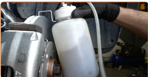
**36** Ξεσφίξτε τη βίδα εξαέρωσης των φρένων. Χρησιμοποιήστε ένα γερμανοπολύγωνο #10.
