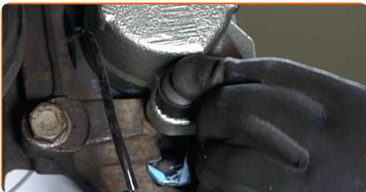
**28** Τοποθετήστε το κλιπ συγκράτησης του τακακιού φρένων. Χρησιμοποιήστε ένα λοστό.
