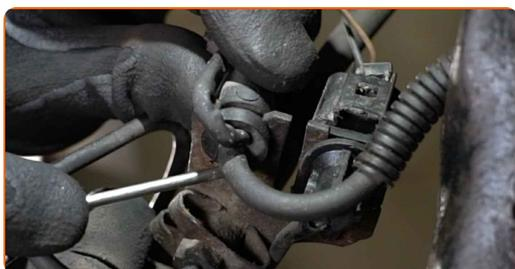
**8** Αποσυνδέστε τον αισθητήρα φθοράς των τακακιών των φρένων. Χρησιμοποιήστε ένα λοστό.
