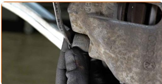
**15** Ξεβιδώστε τον σφιγκτήρα της δαγκάνας των φρένων. Χρησιμοποιήστε ένα Άλεν No.H7. Χρησιμοποιήστε μια κασάνια.
