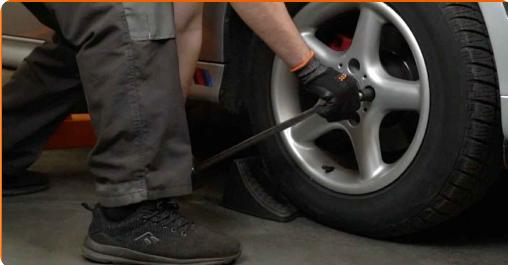
8 Σηκώστε το μπροστινό μέρος του αυτοκινήτου και στερεώστε το σε στηρίγματα.
