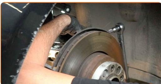
**23** Σφίξτε τη βάση σύσφιξης στο υποπλαίσιο. Χρησιμοποιήστε ένα γερμανοπολύγωνο #18. Χρησιμοποιήστε ένα καρυδάκι #18. Χρησιμοποιήστε ένα δυναμόκλειδο. Σφίξτε τη με ροπή 100 Nm.
