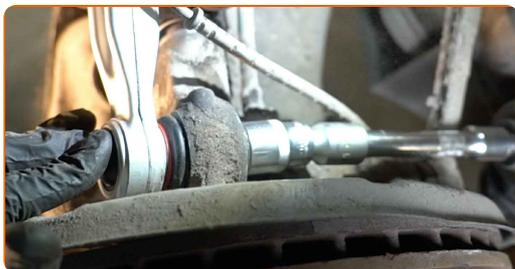
**21** Στηρίξτε το ακραξόνιο. Χρησιμοποιήστε ένα υδραυλικό γρύλο σασμάν.
