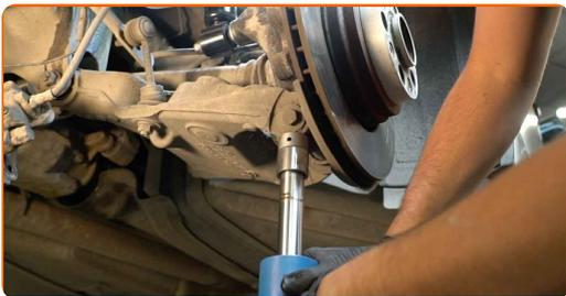
**22** Σφίξτε το στοιχείο στερέωσης που συνδέει το ψαλίδι της ανάρτησης με το οπίσθιο μουαγιέ. Χρησιμοποιήστε ένα καρυδάκι #21. Χρησιμοποιήστε ένα δυναμόκλειδο. Σφίξτε τη με ροπή 165 Nm.
