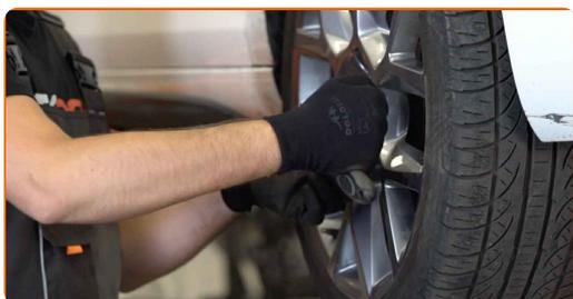
**17** Χαμηλώστε το αυτοκίνητο και χρησιμοποιήστε σταυρό, προκειμένου να σφίξετε τα μπουλόνια των τροχών. Χρησιμοποιήστε ένα δυναμόκλειδο. Σφίξτε τη με ροπή 120 Nm.
