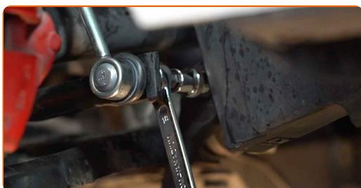
**13** Σφίξτε το στοιχείο στερέωσης που συνδέει το μπαράκι της αντιστρεπτικής στο γόνατο του αμορτισέρ. Χρησιμοποιήστε ένα γερμανοπολύγωνο #18. Χρησιμοποιήστε ένα ΧΖΝ #6. Χρησιμοποιήστε ένα δυναμόκλειδο. Σφίξτε τη με ροπή 65 Nm.
