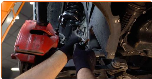
**12** Σφίξτε το στοιχείο στερέωσης που συνδέει το μπαράκι της αντιστρεπτικής στην αντιστρεπτική δοκό. Χρησιμοποιήστε ένα γερμανοπολύγωνο #18. Χρησιμοποιήστε ένα ΧΖΝ #6. Χρησιμοποιήστε ένα δυναμόκλειδο. Σφίξτε τη με ροπή 65 Nm.
