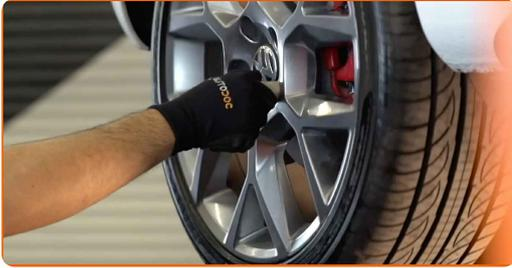
**19** Χαμηλώστε το αυτοκίνητο και χρησιμοποιήστε σταυρό, προκειμένου να σφίξετε τα μπουλόνια των τροχών. Χρησιμοποιήστε ένα δυναμόκλειδο. Σφίξτε τη με ροπή 120 Nm.
