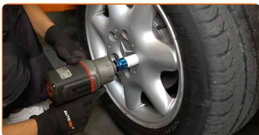
**29** Χαμηλώστε το αυτοκίνητο και χρησιμοποιήστε σταυρό, προκειμένου να σφίξετε τα μπουλόνια των τροχών. Χρησιμοποιήστε κρουστικό καρυδάκι για μπουλονόκλειδο No #17. Χρησιμοποιήστε ένα δυναμόκλειδο. Σφίξτε τη με ροπή 110 Nm.
