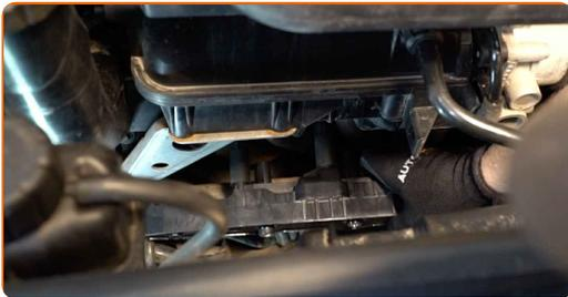
7 Σφίξτε τον πολλαπλασιαστή. Χρησιμοποιήστε ένα καρυδάκι #E11. Χρησιμοποιήστε ένα δυναμόκλειδο. Σφίξτε τη με ροπή 12 Nm.
