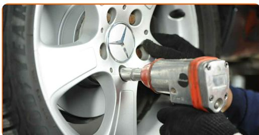
**26** Χαμηλώστε το αυτοκίνητο και χρησιμοποιήστε σταυρό, προκειμένου να σφίξετε τα μπουλόνια των τροχών. Χρησιμοποιήστε κρουστικό καρυδάκι για μπουλονόκλειδο No #17. Χρησιμοποιήστε ένα δυναμόκλειδο. Σφίξτε τη με ροπή 120 Nm.
