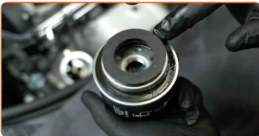
**15** Βιδώστε το φίλτρο στη θέση του. Χρησιμοποιήστε ένα καρυδάκι 76-14F. Χρησιμοποιήστε ένα δυναμόκλειδο. Σφίξτε τη με ροπή 25 Nm.
