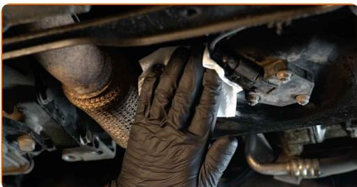
**17** Βιδώστε την καινούρια τάπα αποστράγγισης και σφίξτε τη. Χρησιμοποιήστε ένα καρυδάκι #19. Χρησιμοποιήστε ένα δυναμόκλειδο. Σφίξτε τη με ροπή 26 Nm.
