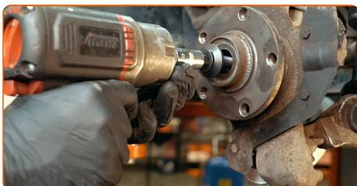
**48** Καθαρίστε την πλήμνη. Χρησιμοποιήστε μια συρματόβουρτσα. Καθαρίστε το σημείο επαφής. Χρησιμοποιήστε γράσο χαλκού.
