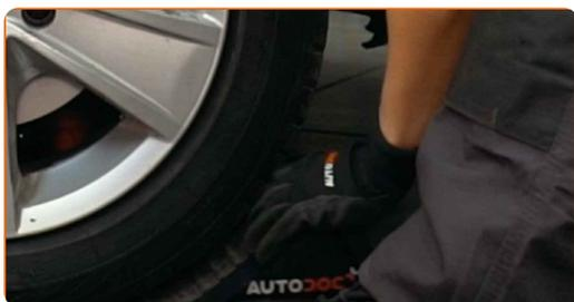
**2** Χαλαρώστε τα στοιχεία στερέωσης του ημιαξονίου. Χρησιμοποιήστε ένα Άλεν No.H14. Χρησιμοποιήστε μια μανέλα κολαούζου.
