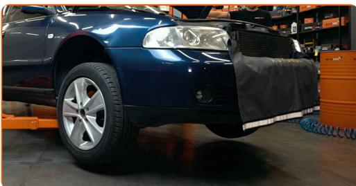
**59** Σφίξτε τη βίδα που συνδέει τον άξονα κίνησης με την πλήμνη του τροχού. Χρησιμοποιήστε ένα Άλεν No.H14. Χρησιμοποιήστε ένα δυναμόκλειδο. Σφίξτε τη με ροπή 115 Nm.+180°
