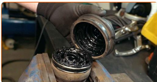
**28** Βγάλτε το ρουλεμάν του μπιλιοφόρου. Χρησιμοποιήστε ένα λοστό.
