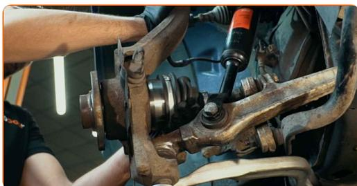
**44** Τοποθετήστε τους βραχίονες ελέγχου.
