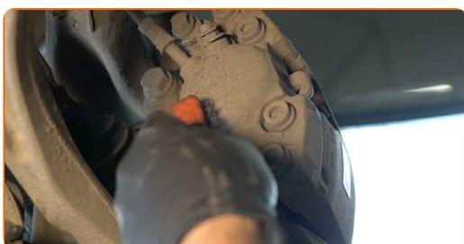
**33** Ξεβιδώστε τον σφιγκτήρα της δαγκάνας των φρένων. Χρησιμοποιήστε ένα καρυδάκι #13. Χρησιμοποιήστε μια κασάνια.
