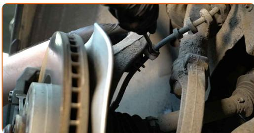
**32** Καθαρίστε τα στοιχεία στερέωσης της δαγκάνας των φρένων. Χρησιμοποιήστε μια συρματόβουρτσα. Χρησιμοποιήστε σπρέι WD-40.
