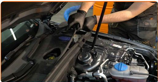
**5** Καθαρίστε τα στοιχεία στερέωσης της επάνω βάση του γόνατου του αμορτισέρ. Χρησιμοποιήστε μια συρματόβουρτσα. Χρησιμοποιήστε σπρέι WD-40.
