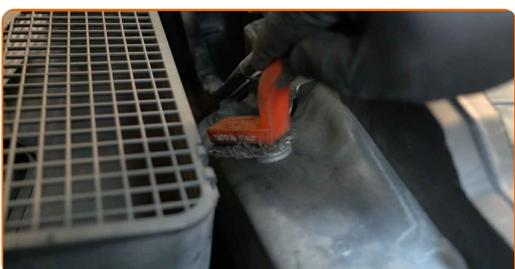
**6** Χαλαρώστε το επάνω στοιχείο στερέωσης της βάσης του γόνατου του αμορτισέρ. Χρησιμοποιήστε ένα καρυδάκι #16. Χρησιμοποιήστε μια κασάνια.
