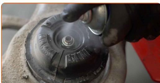
**51** Βγάλτε το παξιμάδι της ράβδου του έμβολου του γονάτου. Χρησιμοποιήστε ένα καρυδάκι #18. Χρησιμοποιήστε ένα Άλεν Νο.Η6 Χρησιμοποιήστε μια καστάνια.
