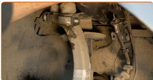
**26** Καθαρίστε τον ακροδέκτη του αισθητήρα ABS. Χρησιμοποιήστε μία συρματόβουρτσα καθαρισμού νάιλον. Χρησιμοποιήστε σπρέι WD-40.
