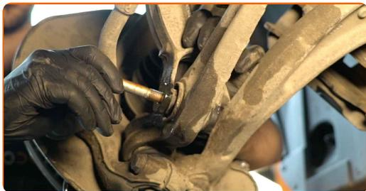
**76** Βιδώστε τα στοιχεία στερέωσης που συνδέουν το ψαλίδι του γονάτου ανάρτησης με τον κάτω βραχίονα ελέγχου. Χρησιμοποιήστε ένα γερμανοπολύγωνο #18. Χρησιμοποιήστε ένα καρυδάκι #18. Χρησιμοποιήστε μια κασάνια.
