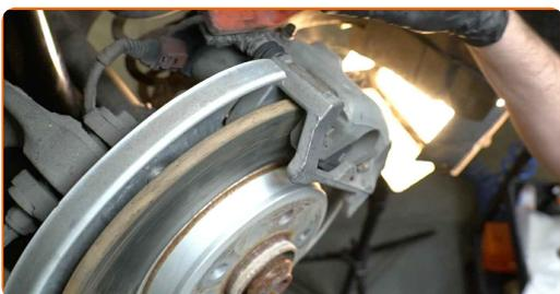
**9** Ξεβιδώστε τον σφιγκτήρα της δαγκάνας των φρένων. Χρησιμοποιήστε ένα γερμανοπολύγωνο #15. Χρησιμοποιήστε ένα καρυδάκι #13. Χρησιμοποιήστε μια καστίνα.
