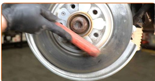
**17** Ξεβιδώστε τις βίδες του δίσκου των φρένων. Χρησιμοποιήστε ένα Τορξ T30. Χρησιμοποιήστε ένα κρουστικό κατσαβίδι χειρός.
