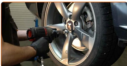
**35** Χαμηλώστε το αυτοκίνητο και χρησιμοποιήστε σταυρό, προκειμένου να σφίξετε τα μπουλόνια των τροχών. Χρησιμοποιήστε κρουστικό καρυδάκι για μπουλονόκλειδο Νο #17. Χρησιμοποιήστε ένα δυναμόκλειδο. Σφίξτε τη με ροπή 120 Nm.
