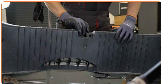
**88** Βιδώστε το στοιχείο στερέωσης του κεντρικού πλαστικού πάνελ προστασίας. Χρησιμοποιήστε ένα σταυροκατσάβιδο.
