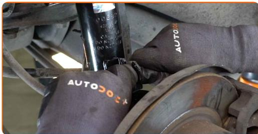
**68** Τοποθετήστε το κλιπ συγκράτησης του μαρκουτσιού των φρένων. Χρησιμοποιήστε ένα λοστό.
