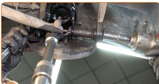
**59** Βιδώστε το στοιχείο στερέωσης που συνδέει τον αμορτισέρ με το πίσω ακραξόνιο. Χρησιμοποιήστε ένα γερμανοπολύγωνο #19. Χρησιμοποιήστε ένα καρυδάκι #19. Χρησιμοποιήστε μια καστάνια.
