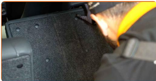
**5** Ξεβιδώστε το στοιχείο στερέωσης του κεντρικού πλαστικού πάνελ προστασίας. Χρησιμοποιήστε ένα σταυροκατσάβιδο.
