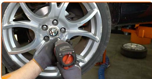
**76** Χαμηλώστε το αυτοκίνητο και χρησιμοποιήστε σταυρό, προκειμένου να σφίξετε τα μπουλόνια των τροχών. Χρησιμοποιήστε κρουστικό καρυδάκι για μπουλονόκλειδο No #17. Χρησιμοποιήστε ένα δυναμόκλειδο. Σφίξτε τη με ροπή 108 Nm.
