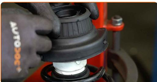
**49** Σφίξτε το παξιμάδι της ράβδου του εμβόλου του γονάτου του αμορτισέρ. Χρησιμοποιήστε ένα καρυδάκι #22. Χρησιμοποιήστε ένα Άλεν Νο.Η6. Χρησιμοποιήστε ένα δυναμόκλειδο. Σφίξτε τη με ροπή 65 Nm.
