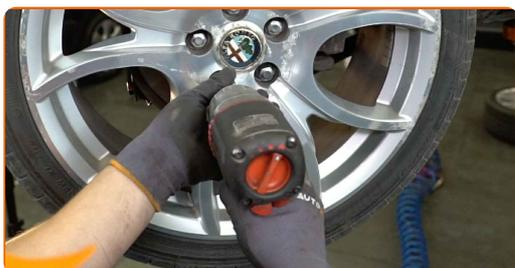
**26** Χαμηλώστε το αυτοκίνητο και χρησιμοποιήστε σταυρό, προκειμένου να σφίξετε τα μπουλόνια των τροχών. Χρησιμοποιήστε κρουστικό καρυδάκι για μπουλονόκλειδο Νο #17. Χρησιμοποιήστε ένα δυναμόκλειδο. Σφίξτε τη με ροπή 108 Nm.
