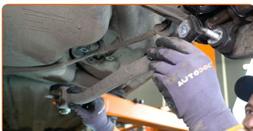
**12** Καθαρίστε τις βάσεις τοποθέτησης και το σπείρωμα του ψαλιδιού της ανάρτησης. Χρησιμοποιήστε μια συρματόβουρτσα. Χρησιμοποιήστε σπρέι WD-40.
