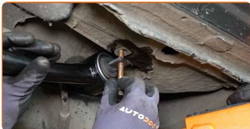
**15** Βιδώστε το πίσω στοιχείο στερέωσης που συνδέει το βραχίονα ελέγχου με το αμάξωμα του αυτοκινήτου. Χρησιμοποιήστε ένα καρυδάκι #15. Χρησιμοποιήστε μια καστίνα.
