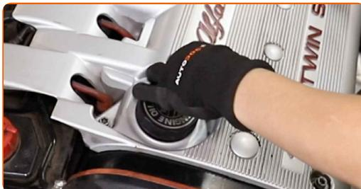
27 Σφίξτε τα στοιχεία στερέωσης του καλύμματος του κινητήρα. Χρησιμοποιήστε ένα Τορξ T40. Χρησιμοποιήστε μια καστάνια.
