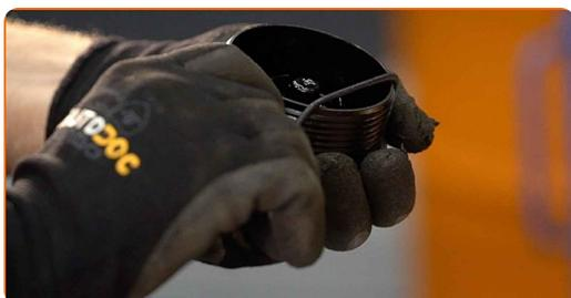
**16** Τοποθετήστε το καινούριο φίλτρο λαδιού στη θέση του επάνω στο περίβλημά του.
