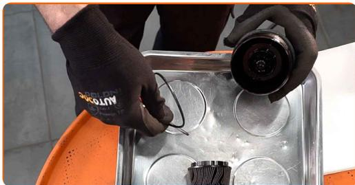
**14** Καθαρίστε το καπάκι του περιβλήματος του φίλτρου λαδιού. Χρησιμοποιήστε ένα σπρέι καθαρισμού γενικής χρήσης.
