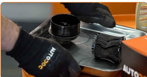
**13** Αφαιρέστε το ο-ριγκ του καπακιού του φίλτρου. Χρησιμοποιήστε ένα ίσιο κατσαβίδι.
