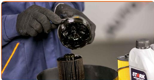
**9** Καθαρίστε το καπάκι του περιβλήματος του φίλτρου λαδιού. Χρησιμοποιήστε ένα σπρέι καθαρισμού γενικής χρήσης.
