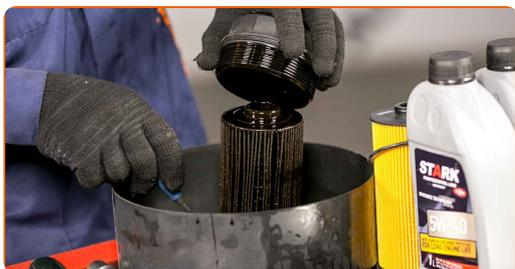
**8** Αφαιρέστε το ο-ρινγκ του καπακιού του φίλτρου. Χρησιμοποιήστε ένα ίσιο κατσαβίδι.
