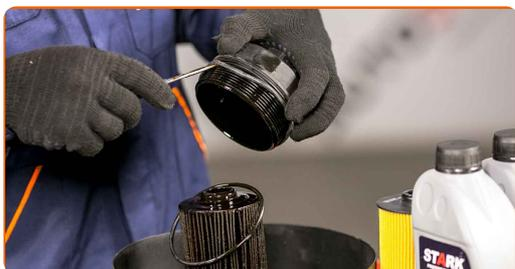
**11** Τοποθετήστε το καινούριο φίλτρο λαδιού στη θέση του επάνω στο περίβλημά του.
