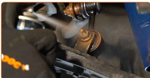
**20** Καθαρίστε το σημείο τοποθέτησης της ζάντας του τροχού. Χρησιμοποιήστε μια συρματοβούρτσα.
