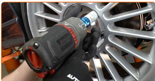
**25** Χαμηλώστε το αυτοκίνητο και χρησιμοποιήστε σταυρό, προκειμένου να σφίξετε τα μπουλόνια των τροχών. Χρησιμοποιήστε κρουστικό καρυδάκι για μπουλονόκλειδο Νο #17. Χρησιμοποιήστε ένα δυναμόκλειδο. Σφίξτε τη με ροπή 120 Nm.
