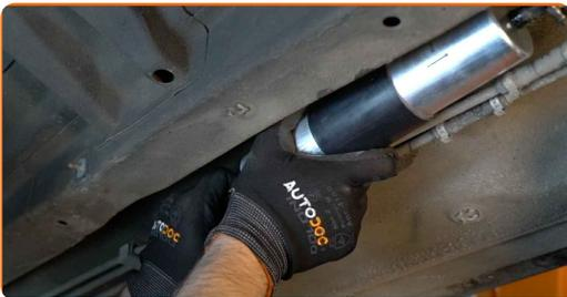
**18** Βιδώστε τη βάση στήριξης του φίλτρου καυσίμου. Χρησιμοποιήστε ένα Άλεν No.H5. Χρησιμοποιήστε μια καστάνια.
