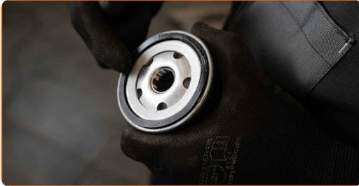
**16** Βιδώστε το φίλτρο στη θέση του. Χρησιμοποιήστε ένα καρυδάκι 76/14-F. Να τηρείτε τη συνιστώμενη ροπή σύσφιξης.
