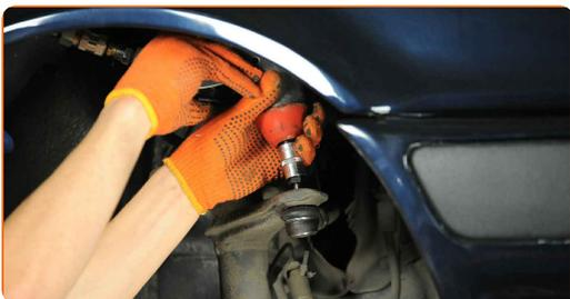
**16** Σφίξτε το παξιμάδι σύνδεσης του μπαλακιού με το ακρόμπαρο. Χρησιμοποιήστε ένα γερμανοπολύγωνο #14. Χρησιμοποιήστε ένα γερμανοπολύγωνο #22. Χρησιμοποιήστε ένα δυναμόκλειδο. Σφίξτε τη με ροπή 40 Nm.
