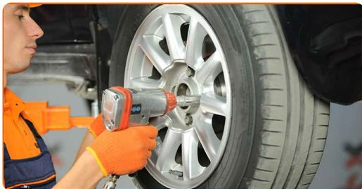
**29** Χαμηλώστε το αυτοκίνητο και χρησιμοποιήστε σταυρό, προκειμένου να σφίξετε τα μπουλόνια των τροχών. Χρησιμοποιήστε κρουστικό καρυδάκι για μπουλονόκλειδο No #17. Χρησιμοποιήστε ένα δυναμόκλειδο. Σφίξτε τη με ροπή 120 Nm.
