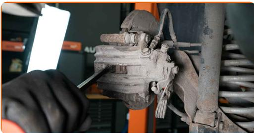
**9** Καθαρίστε τα στοιχεία στερέωσης της δαγκάνας των φρένων. Χρησιμοποιήστε μια συρματόβουρτσα. Χρησιμοποιήστε καθαριστικό φρένων.
