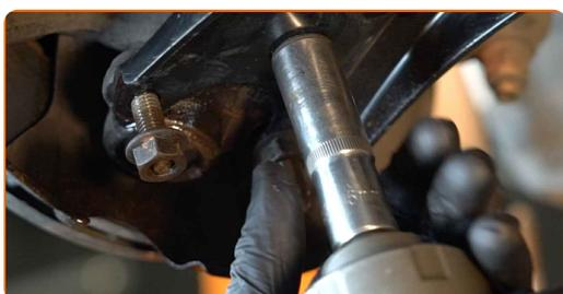
**17** Τοποθετήστε το οπίσθιο στοιχείο στερέωσης του ψαλιδιού.
