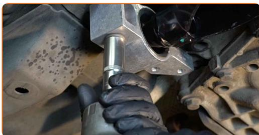
**19** Τοποθετήστε το οπίσθιο στοιχείο στερέωσης του ψαλιδιού.
