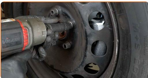
**33** Χαμηλώστε το αυτοκίνητο και χρησιμοποιήστε σταυρό, προκειμένου να σφίξετε τα μπουλόνια των τροχών. Χρησιμοποιήστε κρουστικό καρυδάκι για μπουλονόκλειδο Νο #17. Χρησιμοποιήστε ένα δυναμόκλειδο. Σφίξτε τη με ροπή 120 Nm.
