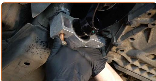
**18** Βιδώστε το πίσω στοιχείο στερέωσης που συνδέει το βραχίονα ελέγχου με το αμάξωμα του αυτοκινήτου. Χρησιμοποιήστε ένα γερμανοπολύγωνο #18. Χρησιμοποιήστε ένα καρυδάκι #18. Χρησιμοποιήστε μια κασάνια.
