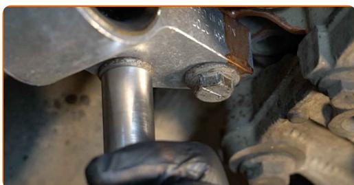
**21** Βιδώστε τα παξιμάδια του εμπρόσθιου ψαλιδιού. Χρησιμοποιήστε ένα καρυδάκι #18. Χρησιμοποιήστε μια καστάνια.
