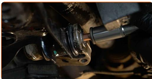
**22** Στηρίξτε το ψαλίδι. Χρησιμοποιήστε ένα υδραυλικό γρύλο σασμάν.
