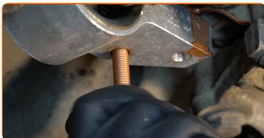
**20** Βιδώστε το πίσω στοιχείο στερέωσης που συνδέει το βραχίονα ελέγχου με το υποπλαίσιο. Χρησιμοποιήστε ένα γερμανοπολύγωνο #16. Χρησιμοποιήστε ένα καρυδάκι #16. Χρησιμοποιήστε μια καστάνια.
