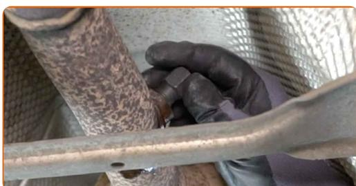
**12** Επεξεργαστείτε τον αισθητήρα οξυγόνου. Χρησιμοποιήστε κεραμικό γράσο υψηλής θερμοκρασίας.
