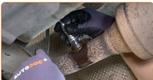
**14** Σφίξτε το στοιχείο στερεώσης του αισθητήρα οξυγόνου. Χρησιμοποιήστε ένα κλειδί σωλήνων φρένων. Χρησιμοποιήστε ένα δυναμόκλειδο. Σφίξτε τη με ροπή 37 Nm.
