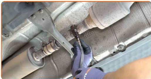
**11** Κόψτε το σπείρωμα για τον καινούριο αισθητήρα οξυγόνου. Χρησιμοποιήστε ένα κολαούζο. Χρησιμοποιήστε μια καστάνια.
