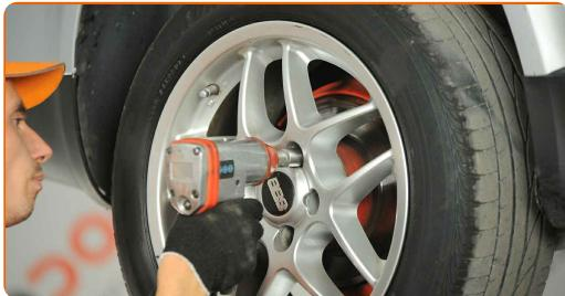
**29** Χαμηλώστε το αυτοκίνητο και χρησιμοποιήστε σταυρό, προκειμένου να σφίξτε τα μπουλόνια των τροχών. Χρησιμοποιήστε ένα δυναμόκλειδο. Σφίξτε τη με ροπή 120 Nm.
