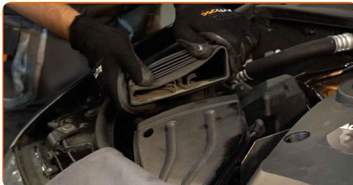
4 Ξεβιδώστε τις βίδες στερέωσης του καλύμματος του φίλτρου αέρα. Χρησιμοποιήστε ένα σταυροκατσάβιδο.
