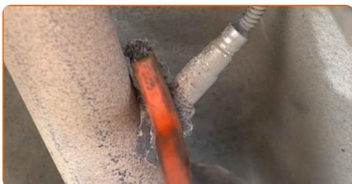
**7** Ξεβιδώστε το στοιχείο στερέωσης του αισθητήρα οξυγόνου. Χρησιμοποιήστε ένα καρυδάκι αισθητήρα οξυγόνου 22 mm. Χρησιμοποιήστε μια κασάνια.
