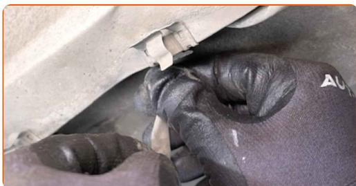
**6** Καθαρίστε το στοιχείο στερέωσης του αισθητήρα οξυγόνου. Χρησιμοποιήστε μια συρματόβουρτσα. Χρησιμοποιήστε σπρέι WD-40.
