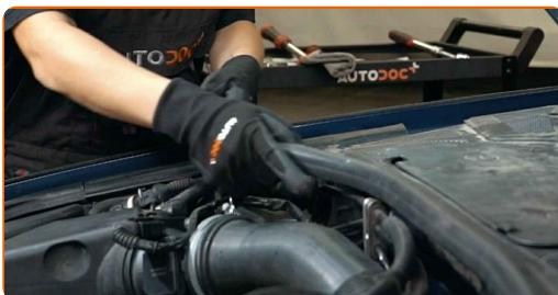
**4** Ξεβιδώστε τα στοιχεία στερέωσης του πλαστικού καλύμματος του νεροχύτη κάτω από τους υαλοκαθαριστήρες. Χρησιμοποιήστε ένα Τορξ T20. Χρησιμοποιήστε ένα ίσιο κατσαβίδι.
