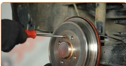
**21** Καθαρίστε το σημείο τοποθέτησης της ζάντας του τροχού. Χρησιμοποιήστε μια συρματόβουρτσα.
