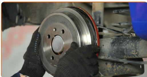
**20** Σφίξτε τα στοιχεία στερέωσης του ταμπόρου των φρένων. Χρησιμοποιήστε ένα σταυροκατσάβιδο. Χρησιμοποιήστε ένα δυναμόκλειδο. Σφίξτε τη με ροπή 4 Nm.
