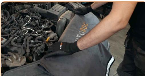
3 Ξεβιδώστε τις βίδες στερέωσης του καλύμματος του φίλτρου αέρα. Χρησιμοποιήστε ένα Τορξ T25. Χρησιμοποιήστε μια καστάνια.
