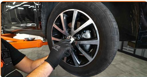
**34** Χαμηλώστε το αυτοκίνητο και χρησιμοποιήστε σταυρό, προκειμένου να σφίξετε τα μπουλόνια των τροχών. Χρησιμοποιήστε ένα δυναμόκλειδο. Σφίξτε τη με ροπή 120 Nm.
