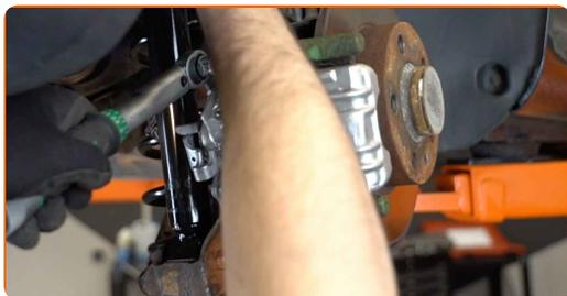
**18** Ξεβιδώστε το άκρο του μαρκουτσιού του φρένου. Χρησιμοποιήστε ένα Άλεν Νο.Η6 Χρησιμοποιήστε μια καστάνια.
