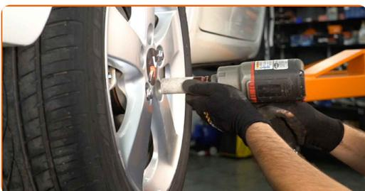
**24** Χαμηλώστε το αυτοκίνητο και χρησιμοποιήστε σταυρό, προκειμένου να σφίξετε τα μπουλόνια των τροχών. Χρησιμοποιήστε ένα δυναμόκλειδο. Σφίξτε τη με ροπή 103 Nm.
