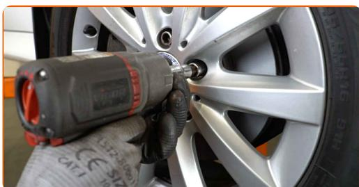
**24** Χαμηλώστε το αυτοκίνητο και χρησιμοποιήστε σταυρό, προκειμένου να σφίξετε τα μπουλόνια των τροχών. Χρησιμοποιήστε κρουστικό καρυδάκι για μπουλονόκλειδο Νο #H12. Χρησιμοποιήστε ένα δυναμόκλειδο. Σφίξτε τη με ροπή 130 Nm.
