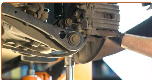
**30** Σφίξτε το κάτω παξιμάδι του γόνατου του αμορτισέρ. Χρησιμοποιήστε ένα γερμανοπολύγωνο #21. Χρησιμοποιήστε ένα καρυδάκι #21. Χρησιμοποιήστε ένα δυναμόκλειδο. Σφίξτε τη με ροπή 150 Nm.+90°
