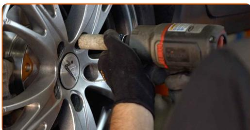
40 Χαμηλώστε το αυτοκίνητο και χρησιμοποιήστε σταυρό, προκειμένου να σφίξετε τα μπουλόνια των τροχών. Χρησιμοποιήστε ένα δυναμόκλειδο. Σφίξτε τη με ροπή 120 Nm.
