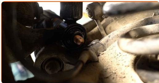
**28** Βιδώστε το κάτω στοιχείο στερέωσης του αμορτισέρ. Χρησιμοποιήστε ένα γερμανοπολύγωνο #21. Χρησιμοποιήστε ένα καρυδάκι #21. Χρησιμοποιήστε μια καστανία.
