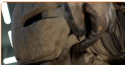
**9** Ξεβιδώστε τον σφιγκτήρα της δαγκάνας των φρένων. Χρησιμοποιήστε ένα Άλεν No.H7. Χρησιμοποιήστε μια καστίνα.
