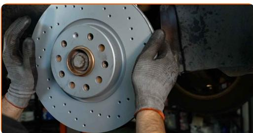
**21** Σφίξτε τις βίδες του δίσκου των φρένων. Χρησιμοποιήστε ένα Τορξ T30. Χρησιμοποιήστε ένα δυναμόκλειδο. Σφίξτε τη με ροπή 4 Nm.
