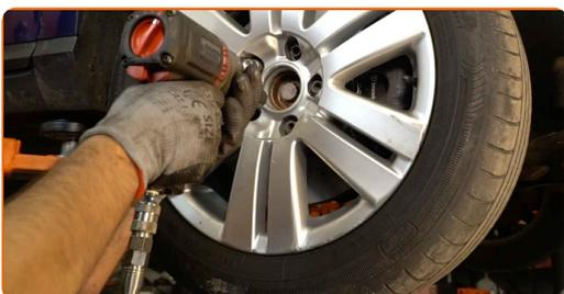
**19** Χαμηλώστε το αυτοκίνητο και χρησιμοποιήστε σταυρό, προκειμένου να σφίξετε τα μπουλόνια των τροχών. Χρησιμοποιήστε κρουστικό καρυδάκι για μπουλονόκλειδο Νο #17. Χρησιμοποιήστε ένα δυναμόκλειδο. Σφίξτε τη με ροπή 120 Nm.
