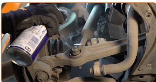
**7** Ξεβιδώστε το κάτω παξιμάδι του γόνατου του αμορτισέρ. Χρησιμοποιήστε ένα γερμανοπολύγωνο #18. Χρησιμοποιήστε ένα καρυδάκι #18. Χρησιμοποιήστε μια καστάνια.
