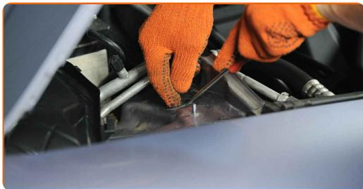
**19** Ξεβιδώστε τα επάνω στοιχεία στερέωσης του γόνατου του αμορτισέρ. Χρησιμοποιήστε ένα καρυδάκι #16. Χρησιμοποιήστε μια καστίνα.
