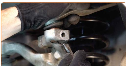
**41** Τοποθετήστε τη βίδα στερέωσης. Χρησιμοποιήστε ένα σφυρί. Χρησιμοποιήστε ένα ζουμπά.
