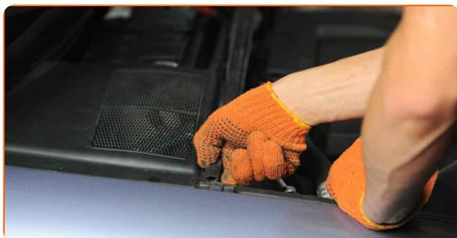
**17** Αφαιρέστε το πλαστικό κάλυμμα των υαλοκαθαριστήρων που βρίσκεται στη δεξιά πλευρά.
