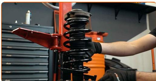
**47** Καθαρίστε τις βάσεις τοποθέτησης του γόνατου του αμορτισέρ. Χρησιμοποιήστε μια συρματόβουρτσα. Χρησιμοποιήστε σπρέι WD-40.
