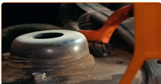
**7** Ξεσφίξτε τα επάνω στοιχεία στερέωσης του γόνατου ανάρτησης. Χρησιμοποιήστε ένα καρυδάκι #13. Χρησιμοποιήστε μια κασάνια.
