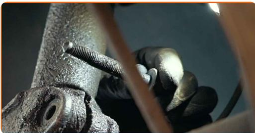
**27** Απελευθερώστε το κάτω στοιχείο στερέωσης που συνδέει το γόνατο του αμορτισέρ με το μουαγιέ. Χρησιμοποιήστε ένα ίσιο σκαρπέλο μετάλλου. Χρησιμοποιήστε ένα σφυρί.
