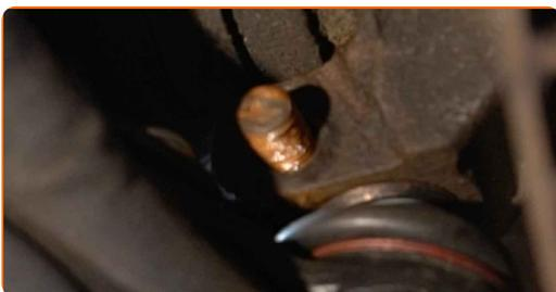
69 Σφίξτε το στοιχείο στερέωσης που συνδέει το μπαλάκι με το ακραξόνιο. Χρησιμοποιήστε ένα γερμανοπολύγωνο #16. Χρησιμοποιήστε ένα καρυδάκι #16. Χρησιμοποιήστε ένα δυναμόκλειδο. Σφίξτε τη με ροπή 40 Nm.
