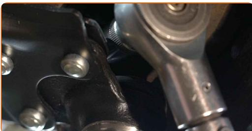
70 Σφίξτε τα κάτω στοιχεία στερέωσης του γόνατου ανάρτησης. Χρησιμοποιήστε ένα γερμανοπολύγωνο #16. Χρησιμοποιήστε ένα καρυδάκι #16. Χρησιμοποιήστε ένα δυναμόκλειδο. Σφίξτε τη με ροπή 55 Nm.
