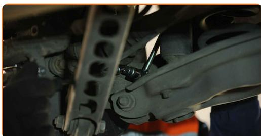
**14** Σφίξτε το στοιχείο στερέωσης που συνδέει το μπαράκι της αντιστρεπτικής στην αντιστρεπτική δοκό. Χρησιμοποιήστε ένα γερμανοπολύγωνο #17 (2 τεμάχια). Χρησιμοποιήστε ένα δυναμόκλειδο. Σφίξτε τη με ροπή 58 Nm.
