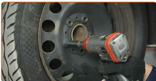
**39** Χαμηλώστε το αυτοκίνητο και χρησιμοποιήστε σταυρό, προκειμένου να σφίξετε τα μπουλόνια των τροχών. Χρησιμοποιήστε κρουστικό καρυδάκι για μπουλονόκλειδο No #17. Χρησιμοποιήστε ένα δυναμόκλειδο. Σφίξτε τη με ροπή 120 Nm.
